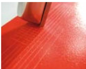
La quadrettatura è un test di tenuta tramite il quale si va a testare l'aderenza delle vernici alla superficie del prodotto e permette di valutare la tenuta all'urto.
